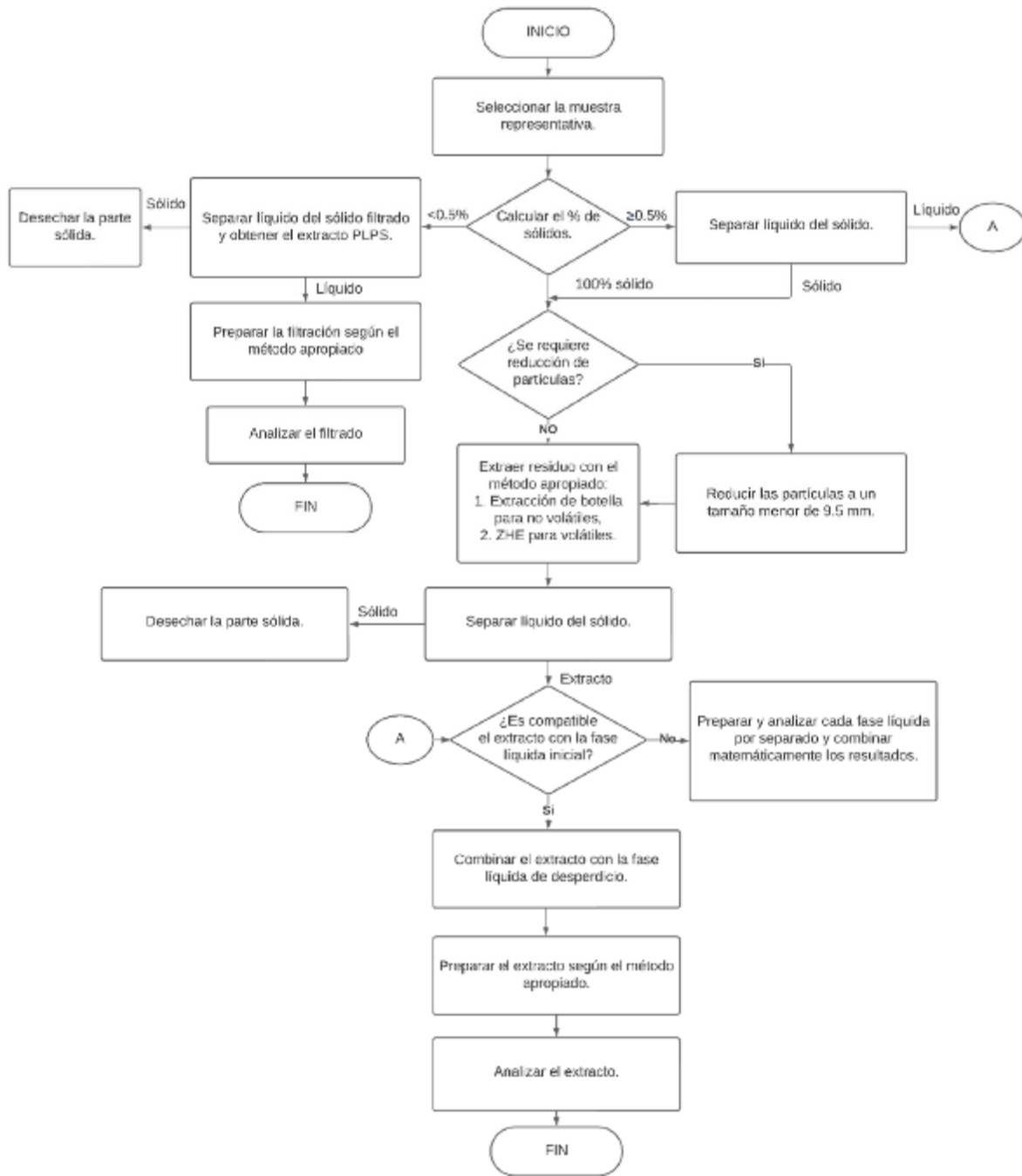
Figura C.2 Procedimiento de lixiviación de precipitación sintética
